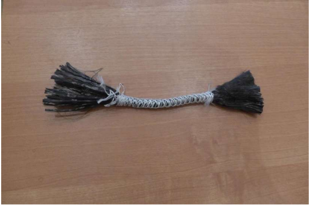
Рисунок 7.3. Общий вид композитных «косичек», используемых в качестве хомутов при усилении простенков
